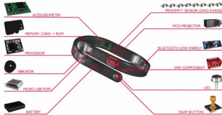
图 2 Cicret 发布的手环结构示意图
